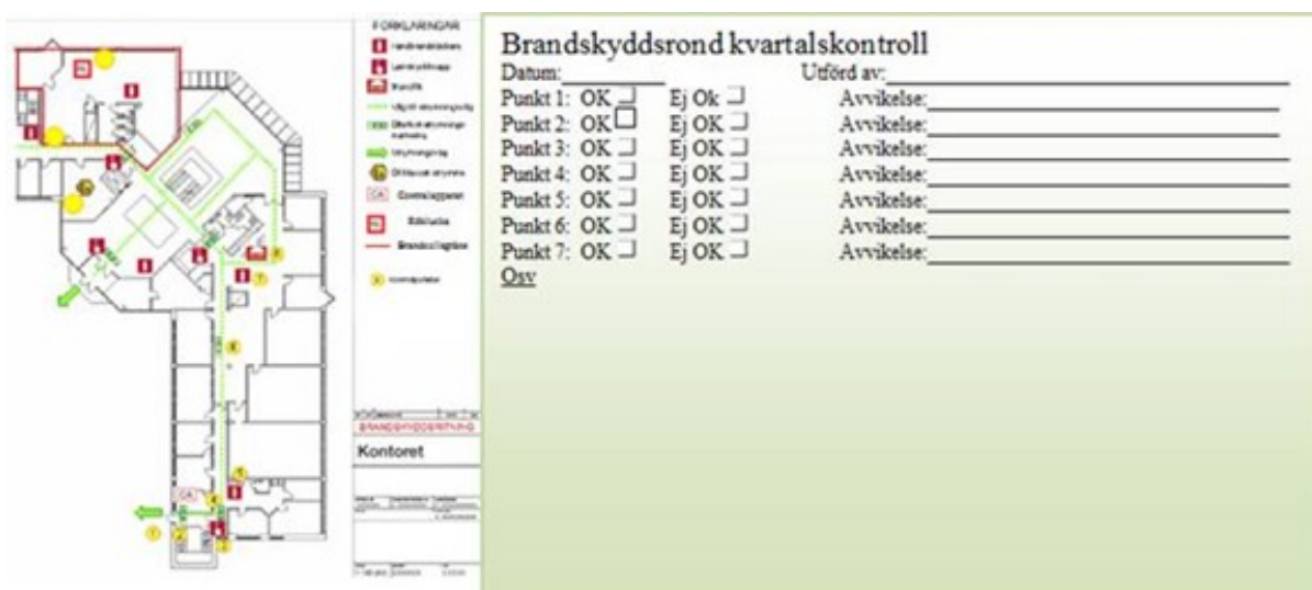
Figur 1, kombinerad brandskyddsritning med kontrollista. Fördelen att kombinera dessa är att det är enkelt att se vilka punkter som ska kontrolleras och vart de finns.
