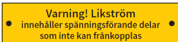
Figur 6 Utmärkning av dolt förlagd kabel, bild från (SEK Handbok 457).
