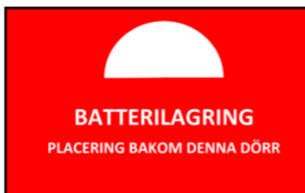
Figur 8 Skylt placerad på dörr till utrymme med batterilagring
