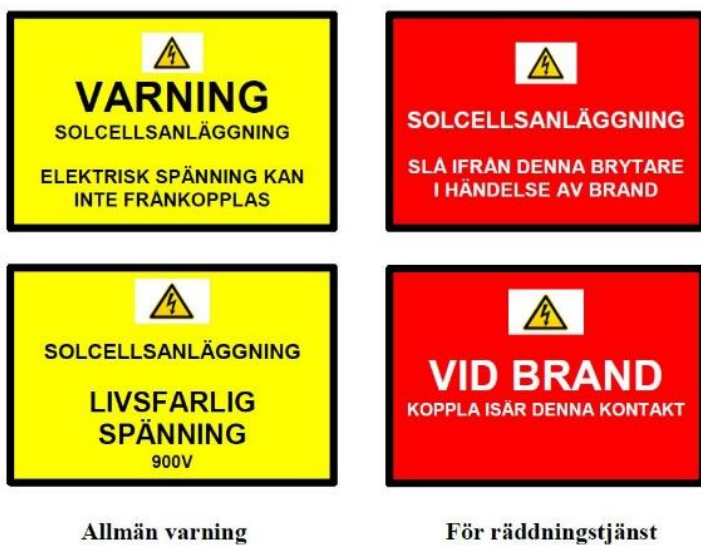
Figur 5 Skyltning vid solcellsanläggning (MSB).
